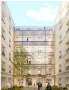
Restructuration de 4 000 m<sup>2</sup> de bureaux sur 5 niveaux, incluant un sous-sol, des commerces sur 320 m<sup>2</sup>. Création d'une double-peau vitrée dans la cour intérieure pour créer une continuité sur chaque plateau et une connexion entre les bâtiments avant et arrière. Création d'une verrière en toiture du R+1 et d'espaces extérieurs végétalisés en toiture.
